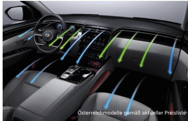
Multi-Air-Modus mit indirekten Lufteinlässen
